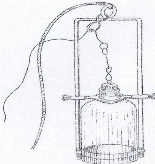
Рис. 2 . Батометр
